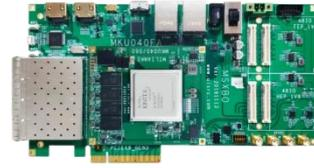
**RX37447** 是一种智能 PCIe 四路光口通讯模块，板载 DDR3，位宽为 64 位，容量为 2G 字节。最大支持 4 路 SFP+光口，光口速率最大支持 10G 速度，可选配 2 路 SFP。此外，RX37447 为标准 PCIe 半长模块，允许将板安装在任何 PCIe 插槽中。
